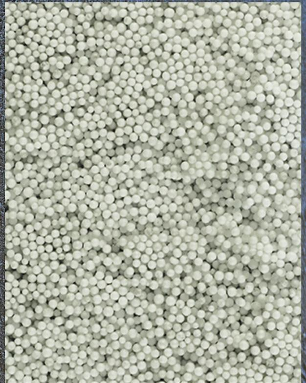
**Le système est un système de remplissage ultraléger pour les dalles en béton intérieures existantes où l'ajout d'une charge permanente à la structure est une préoccupation.**
