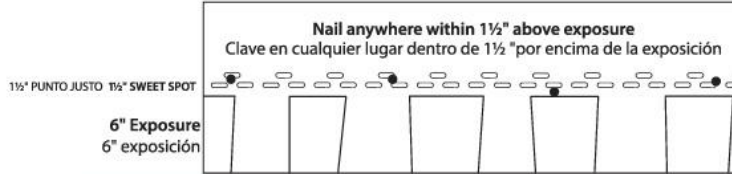
4-Nail Standard Install: 110mph Wind Limited Warranty Instalación estándar de 4 clavos: 110mph de garantía limitada de viento
