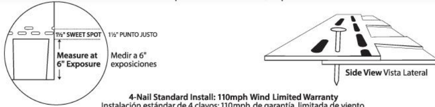
4-Nail Standard Install: 110mph Wind Limited Warranty Instalación estándar de 4 clavos: 110mph de garantía limitada de viento
