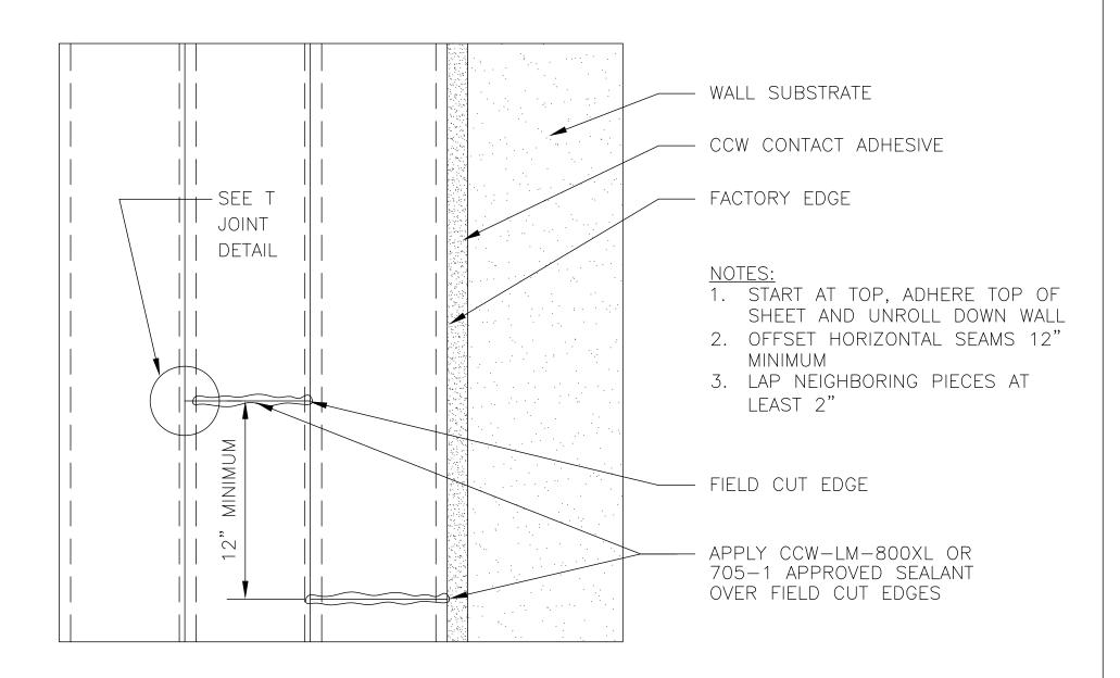
DETAIL IS INTENDED TO BE A GUIDE FOR AIR BARRIER INSTALLATION ONLY.
