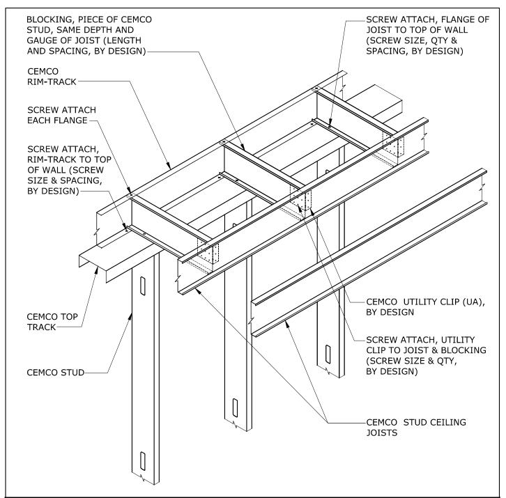
FLUSH CEILING: CEILING PARALLEL TO STUD WALL
