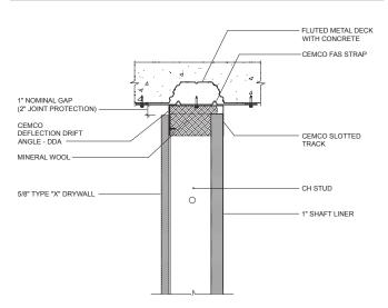
\*NOTE: SINGLE LAYER OF 5/8"TYPE "X" DRYWALL FOR 1 HOUR FIRE RATING, 2 LAYERS FOR 2 HOUR
