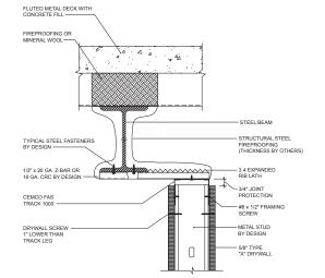
\*NOTE: SINGLE LAYER OF 5/8"TYPE "X" DRYWALL FOR 1 HOUR FIRE RATING, 2 LAYERS FOR 2 HOUR
