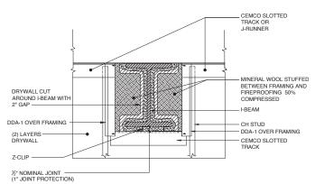
\*NOTE: SINGLE LAYER OF 5/8"TYPE"X" DRYWALL FOR 1 HOUR FIRE RATING, 2 LAYERS FOR 2 HOUR
