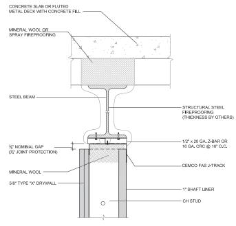
\*NOTE: SINGLE LAYER OF 5/8"TYPE "X" DRYWALL FOR 1 HOUR FIRE RATING, 2 LAYERS FOR 2 HOUR
