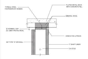
\*NOTE: SINGLE LAYER OF 5/8"TYPE "X" DRYWALL FOR 1 HOUR FIRE RATING, 2 LAYERS FOR 2 HOUR
