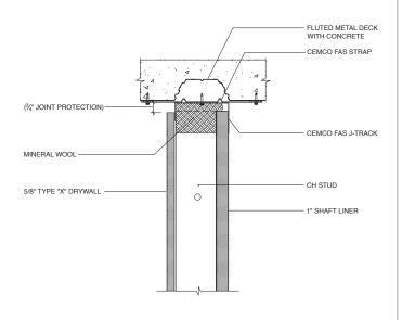
\*NOTE 1: SINGLE LAYER OF 5/8"TYPE "X" DRYWALL FOR 1 HOUR FIRE RATING, 2 LAYERS FOR 2 HOUR \*NOTE 2: NO FIRE SPRAY REQUIRED
