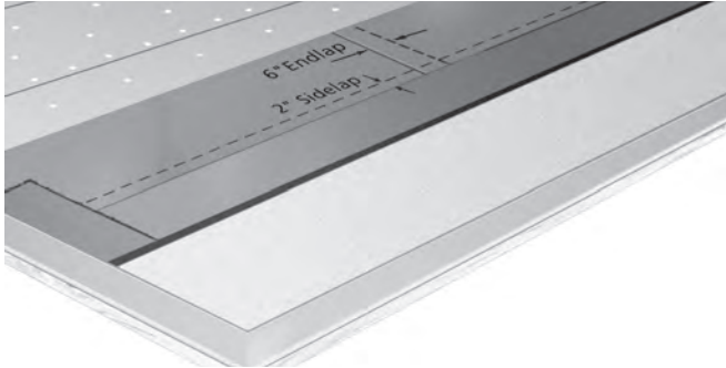
Figure 5-19: Install SA Cap or SA Cap FR at the low point of the roof.
