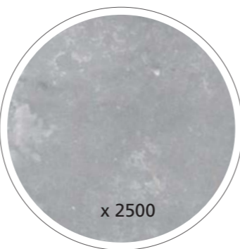
BÉTON DENSIFIÉ PAR LA FORMULE ASHFORD
