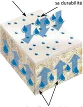
Les agents de scellement pénétrants laissent sortir les vapeurs et permettent à l'humidité de sortir du béton mûri, ce qui réduit le risque de corrosion des barres d'armature
