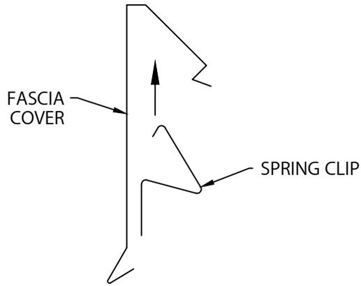
SIMPLY POSITION SPRING CLIP AS SHOWN AND PUSH STRAIGHT UP INTO COVER UNTIL SNAP LOCK OCCURS.
