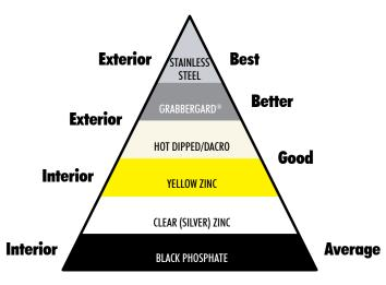
**SCREW RUST & CORROSION RESISTANCE**
