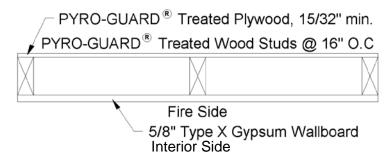
FIGURE 5—1-HOUR FIRE-RESISTANCE-RATED EXTERIOR WALL ASSEMBLY
