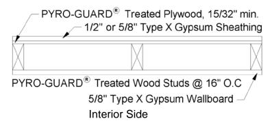
FIGURE 4—1-HOUR FIRE-RESISTANCE-RATED EXTERIOR WALL ASSEMBLY
