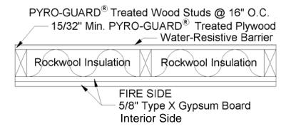
FIGURE 3—2-HOUR FIRE-RESISTANCE-RATED EXTERIOR WALL ASSEMBLY
