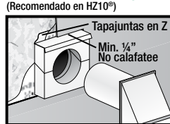
Ilustración 11 Penetración de Bloque (Recomendado en HZ10 ® )
