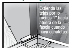
Ilustración 12 Extensión de la Intersección de Limahoyos/Tejas
