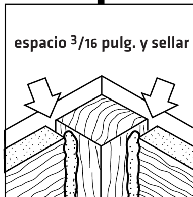
Detalles de la esquina interior
