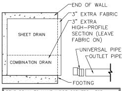
BEND DRAIN TO MAKE INSIDE CORNERS. FOR OUTSIDE CORNERS CUT AND BEND DRAIN TO REACH CORNER AND PROVIDE 3" EXTRA FABRIC TO WRAP AROUND CORNER. ATTACH DRAIN TO WALL AND OVERLAP FABRIC AT JOINT.
