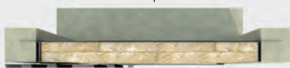
Ensamble de muro completo, recubrimiento mínimo 12"
