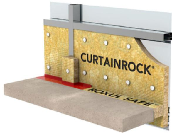
Componentes: Losa de piso de concreto, ROXUL SAFE™, sellador contra incendio, cubierta de columna – CURTAINROCK® travesaño, refuerzos y paneles de muro.
