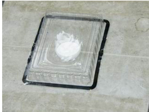
Calcium Chloride ASTM F1869
