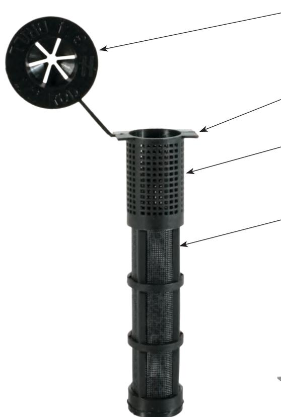
**Tapa integrada:** sirve para centrar y fijar la varilla en el tubo de malla, al mismo tiempo que muestra información importante como el diámetro de la varilla, el diámetro de la broca y el símbolo “#” de Simpson Strong-Tie para facilitar la inspección posterior a la instalación. La tapa también evita que el adhesivo se salga de la parte delantera del tubo de malla.
