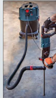
**Broca DXS de Simpson Strong-Tie utilizada con sistema al vacío para la extracción de polvo.\***
