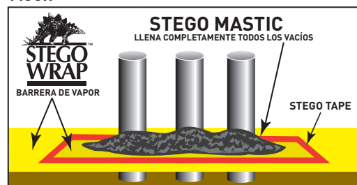
FIGURA 5: SELLADO DE PENETRACIÓN MÚLTIPLE DE TUBERÍAS
