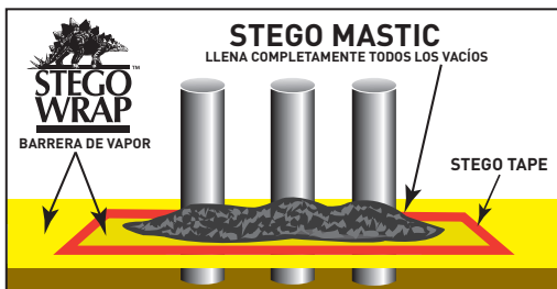
FIGURA 5: SELLADO DE PENETRACIÓN MÚLTIPLE DE TUBERÍAS
