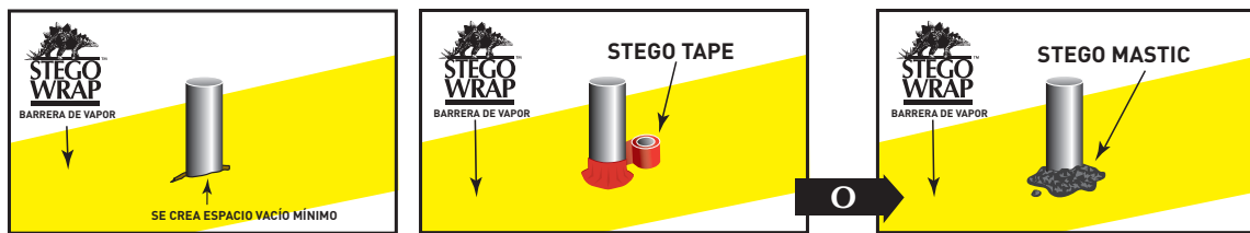
FIGURA 4a: SELLADO DE PENETRACIÓN DE TUBERÍAS
