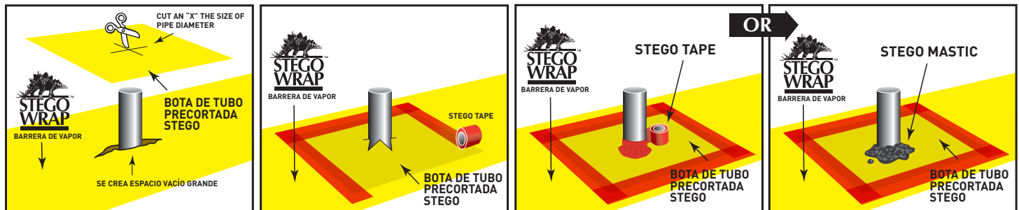
FIGURA 5: SELLADO DE PENETRACIÓN MÚLTIPLE DE TUBERÍAS
