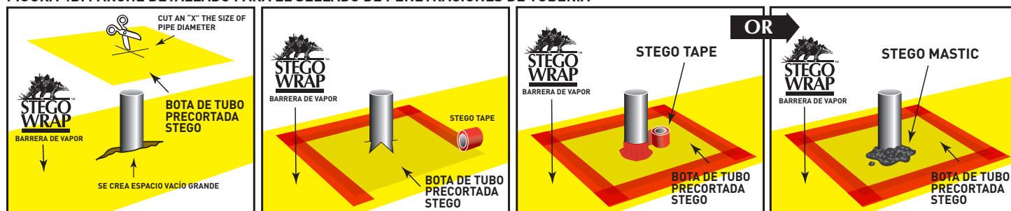
FIGURA 5: SELLADO DE PENETRACIÓN MÚLTIPLE DE TUBERÍAS
