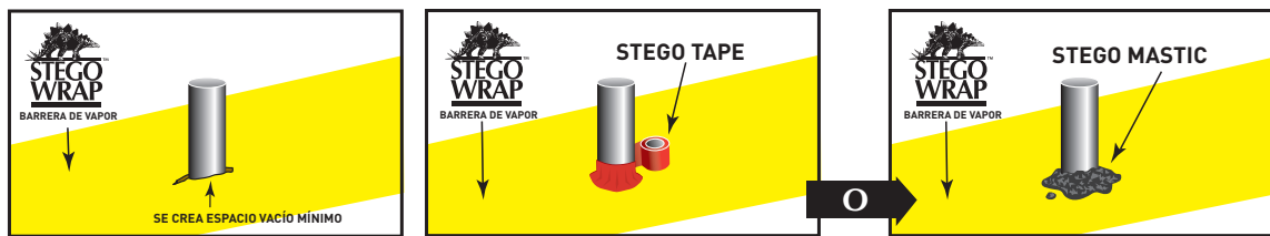
FIGURA 4a: SELLADO DE PENETRACIÓN DE TUBERÍAS
