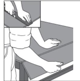
Para hacer las aberturas para tuberías y accesorios, utilice un cuchillo de uso general para cortar a través de las caras en ambos lados y retirar el núcleo de espuma. O bien, use un taladro eléctrico con una broca de sierra circular.
