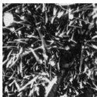
Un bloc de béton de 60 cm x 70 cm x 40 cm est enduit de Concentré. Le bloc est exposé aux éléments pour une année. Par la suite une carotte de 40 cm est extraite du bloc et est sectionnée en 18 morceaux. Ces tranches sont photographiées selon la disposition
